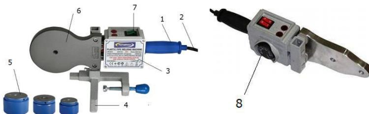
Сварочный аппарат состоит из металлического корпуса (3) и металлической нагревательной панели (6). Металлическая нагревательная панель (6) изготовлена из алюминиевого сплава и имеет антиадгезионное тефлоновое покрытие, которое позволяет производить стыковую (безраструбную) сварку труб.
