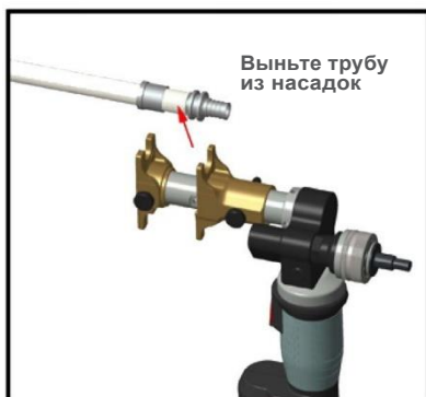
Рис. 5.2. Монтаж аксиальных фитингов с помощью аккумуляторного пресс-инструмента
