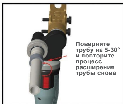
Рис. 5.1 Монтаж аксиальных фитингов с помощью аккумуляторного пресс-инструмента
