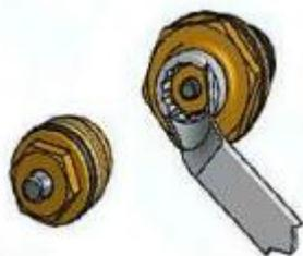
6.5. При течи из-под штока регулирующего клапана, головка клапана может быть снята, отремонтирована или заменена. Головка отвинчивается с помощью гаечного ключа.
